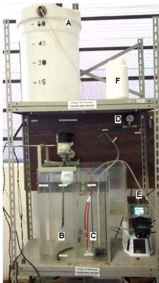
**Figura 2 - Sistema piloto MBRs montado. (A) Tanque de alimentação. (B) Zona anóxica do reator com agitador mecânico e mecanismo de boia. (C) Zona aeróbia do reator com cassete de membranas e difusores. (D) Vacuômetro. (E) Bomba peristáltica. (F) Tanque de permeado.**
